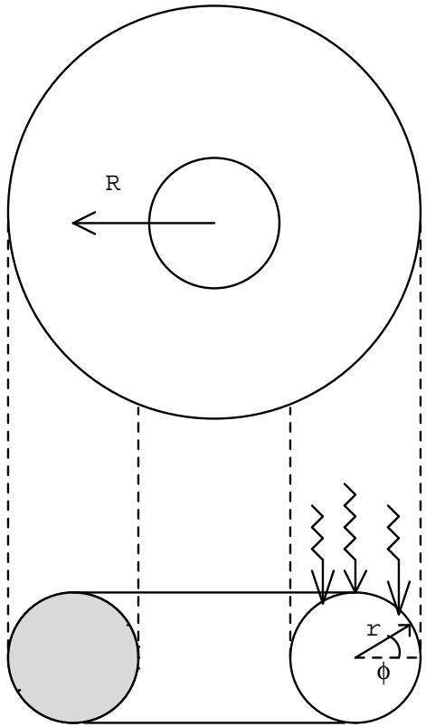
Beschouw de torus uit de figuur. Deze torus wordt door de zon van bovenaf beschinen. Gevraagd wordt het warmteevenwicht in de torus te berekenen. Buiten de straling van de zon zijn er geen warmtebronnen.
