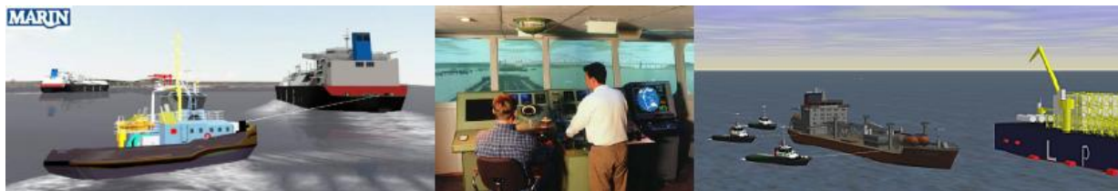
Enkele beelden van de huidige simulator. De golven hebben geen interactie met schepen en omgeving.
